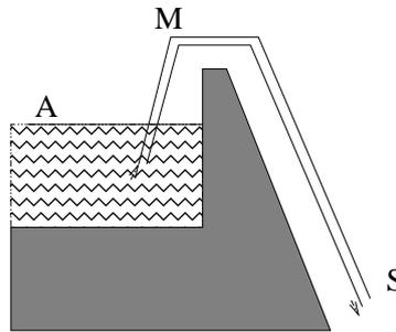
a. On suppose que l'eau s'écoule à la vitesse  $v$ . Quelle est la pression dans la partie haute du syphon ?
